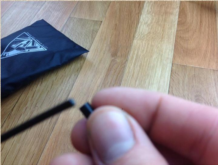
**Schritt 4:** Nehmen Sie sich eine Kneifzange mit scharfer Klinge zur Hand. Mit diesem können sie das Seil an der Markierung auf die richtige Länge schneiden. Es ist sehr wichtig, dass das Messer ausreichend scharf ist,
